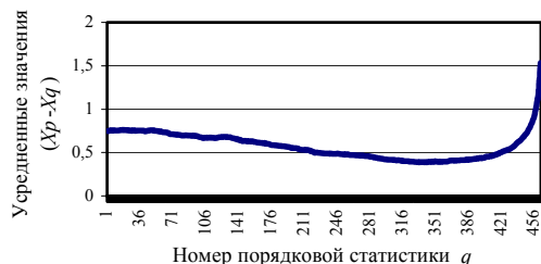
Рис. 4. График зависимости усредненных значений разности X_{(p)} - X_{(q)} от q для случая реализации сигнала (5), \Delta = 50 и ОСШ = 24,79
