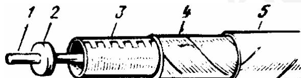
0,15...0,2 мм (4), который покрывается однин-двумя слоями кабельной бумаги (5). Кабель имеет свинцовую оболочку и обычные броневые покровы и маркируется КМБ, КМГ, КМК.
