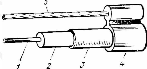
Внутренний проводник кабеля (1) выполнен из медной проволоки диаметром 2,1 мм, изоляция (2) – из пористого полиэтилена с внешним диаметром 9,7 мм, внешний проводник (3) – алюминиевая прессованная трубка толщиной 0,8 мм. Эта же трубка играет роль экрана. Защитная оболочка (4) выполнена из светостойкого полиэтилена толщиной 2,2 мм.
