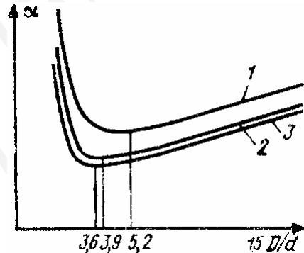
При этом стараются выбирать отклонение соотношения D/d лишь в несколько большую сторону, поскольку отклонение в меньшую связано с довольно резким возрастанием коэффициента затухания.
