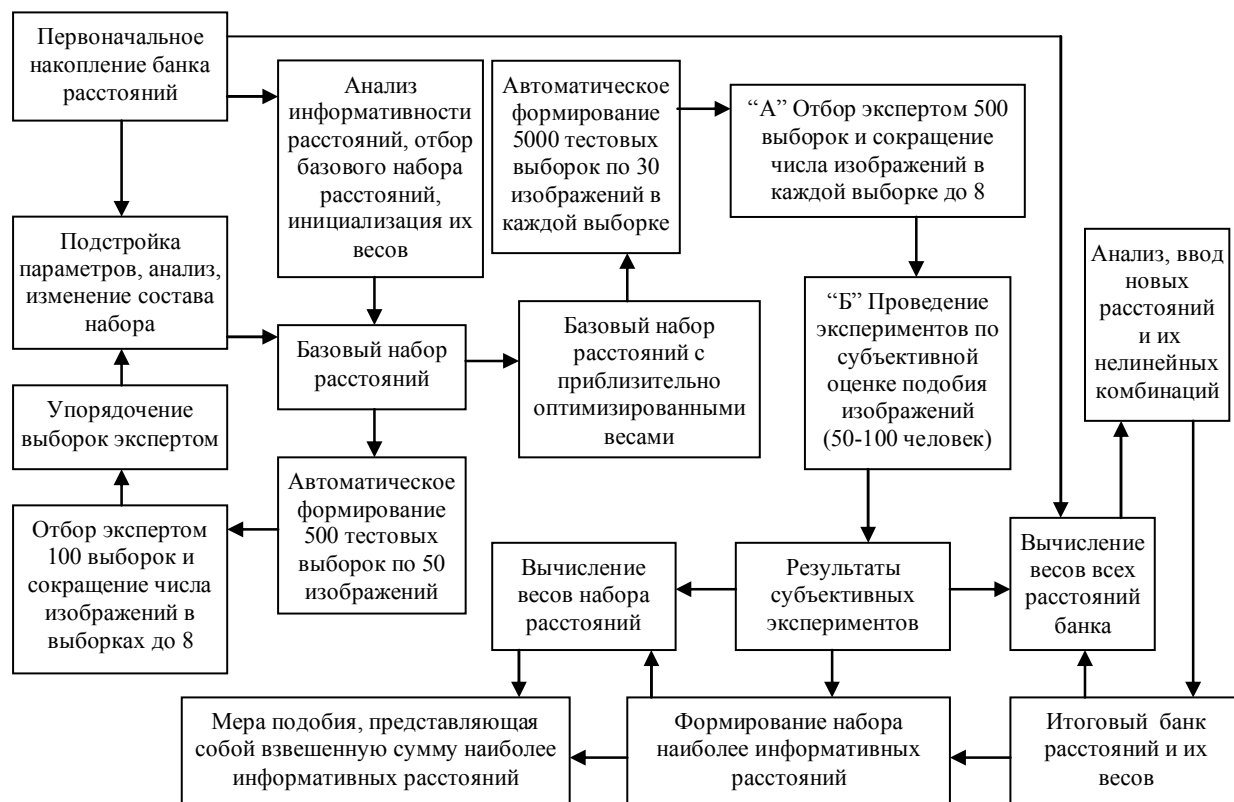
Рис. 2. Структурная схема метода многоэтапной оптимизации весов меры подобию
